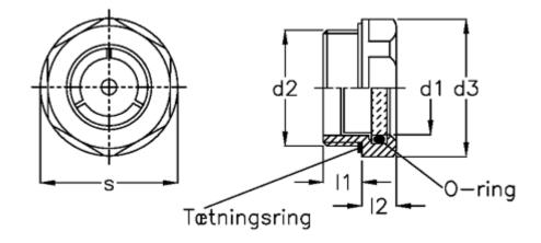
d1 = 32 d2 = M42x1.5 d3 = 50 l1 = 12 l2 = 9 Max pressure = -Max vacuum mbar = s = 46
